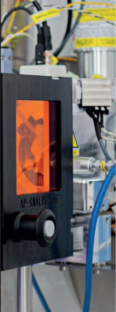
Die bildgebende Massenspektrometrie erlaubt die Untersuchung von Gewebeschnitten und dabei eine genaue Lokalisierung Tausender Moleküle in einem Experiment.
