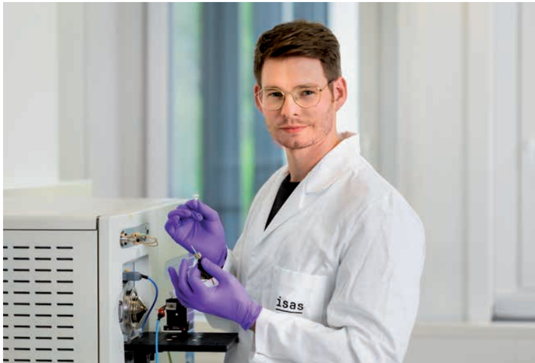
Daniel Foest ist Chemiker und arbeitet als Doktorand in der Arbeitsgruppe Miniaturisierung. In seiner Hand hält er ein Papier mit einer Leberprobe, die er mittels Paper-Spray-Ionisierung am Massenspektrometer untersucht.
